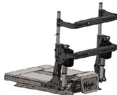
Encosto anti-fricção reclinável elétrico 0° a 150°
